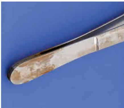
Abb. 3: Beispiel Oberflächenveränderung Spaltkorrosion, Flächenkorrosion
