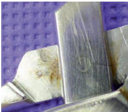
Abb. 4: Beispiel Oberflächenveränderung Spannungsrisskorrosion
