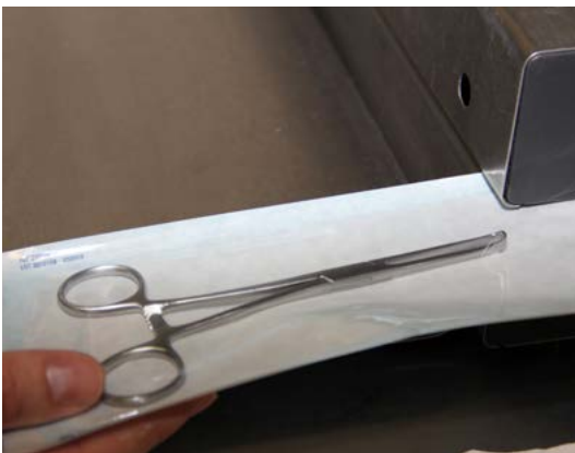
Die Folien-/Papierverpackung erhält eine Siegelnaht
